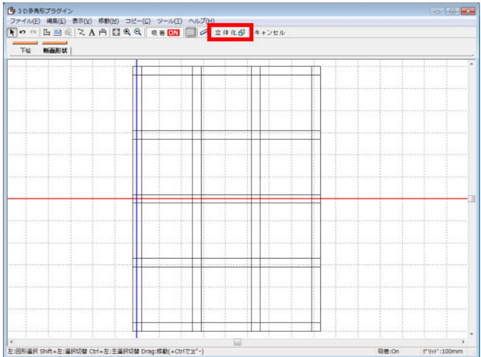
2) 立体化された形状は原点から手前 10000(Y:-10000.00)の地点に寝そべった状態で生成されます。立体化された形状をダブルクリックし、[パーツのプロパティ]で Y: 0.0、RX:90.00 と入力して[OK]をクリックします。
